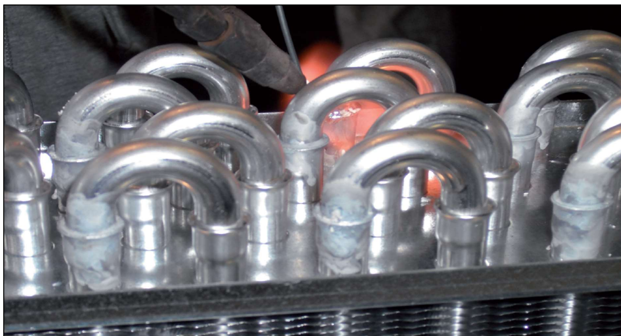
Obrázek 40 Pájení hliníku (kondenzátory)
