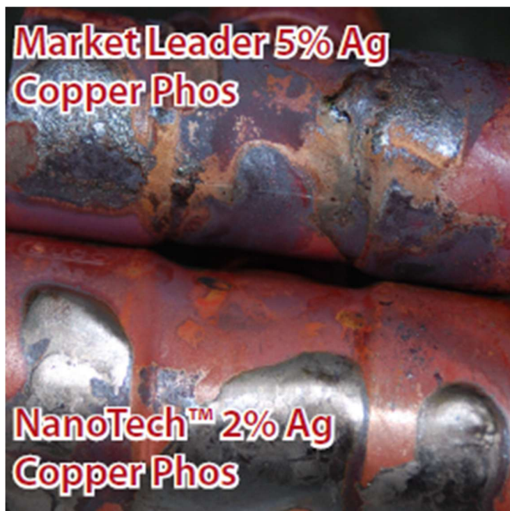
Obrázek 25 Srovnání NanoTech technologie Galflo a konkurence
