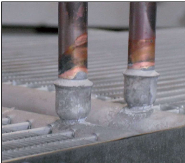
Obrázek 41 Pájení hliníku (měď – hliník)
