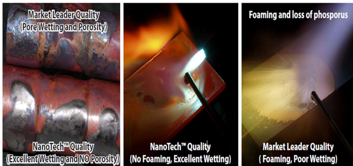
Obrázek 27 Srovnání kvality NanoTech technologie Galflo a kvality konkurence na trhu
