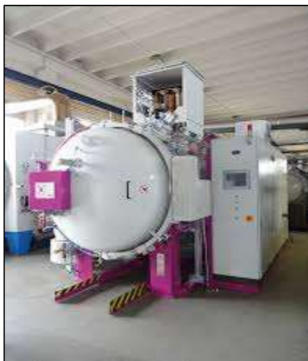
Obrázek 17 Pájení ve vakuu
