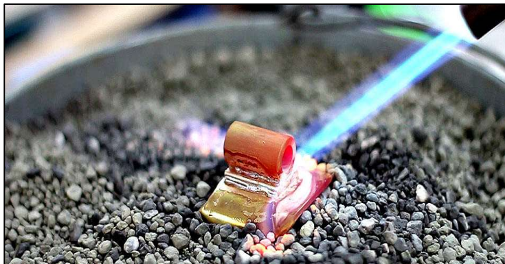
Obrázek 2 Technologie tvrdého pájení
